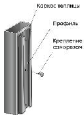
1) СХЕМА МОНТАЖА ПРОФИЛЯ К КАРКАСУ ТЕПЛИЦЫ
